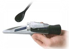
サンプルをプリズム面に1~2滴 滴下してください
