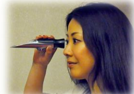
蓋板を閉じ、明るい方向を向いて 接眼鏡を覗いてください
