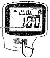
手順 5 「+」か「-」どちらかのボタンを押し、希望の数値に設定します。工場出荷時には全レンジを「100」に設定していますが、以前設定を変更された場合はその数字が表示されます。可変範囲は0~199まで値を変えられます。1秒以上長押しすると連続して数字が変化します。
