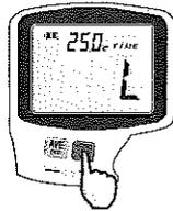
手順 2 表示されている本体温度と測定物の温度をできるだけ同じにしてから測定を開始してください。
