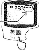
手順 3 「+」か「-」ボタンを同時に押すと「0.0」と表示が出ます。工場出荷時には全レンジ「0.0」に設定していますが、以前設定を変更された場合はその数字が表示されます。
