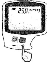
手順 4 センサー先端部を測定物にあてて、本体の「START」またはセンサー部の「測定」ボタンを押して測定を開始します。
